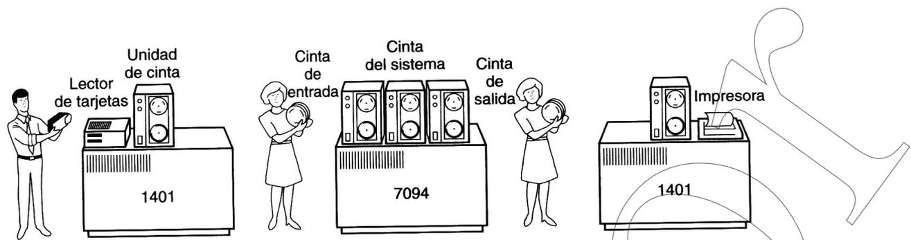
Ilustración 1-2: Procesamiento por lotes usando equipos auxiliares
